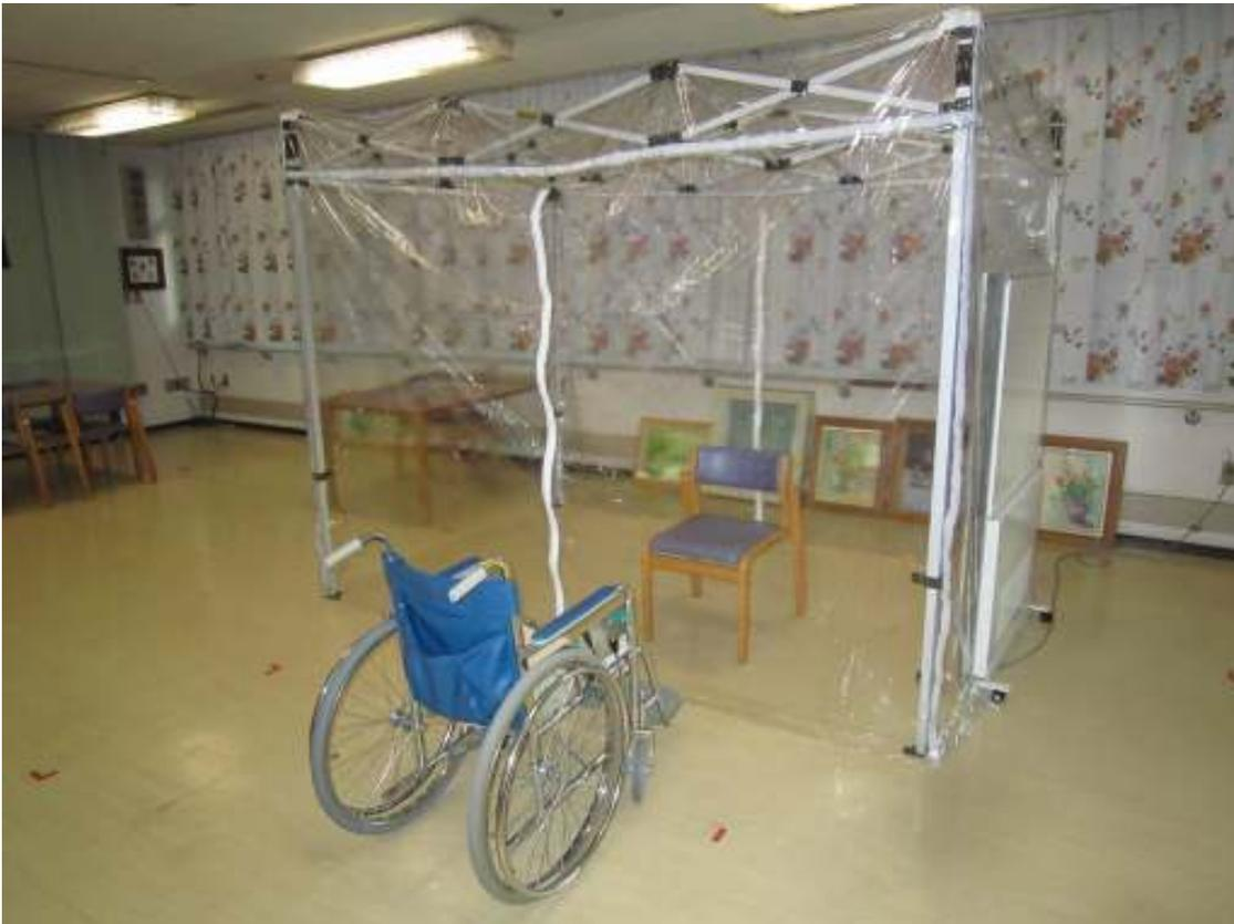
空気清浄装置が可動している陰圧ブースは透明のビニールテントで覆われています。
